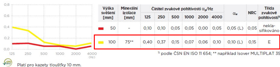
Obr. 2 Činitel zvukové pohltivosti \alpha akustického podhledu Base 31 – převzato z technické dokumentace RIGIPS
